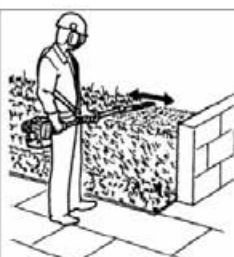
Fig.HT11 Corte horizontal: corte sin permanecer directamente en frente del seto (ej.: sobre un macizo de flores)
