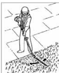
Fig.HT10 Corte horizontal: corte cerca del suelo desde la posición de pie (ej.: matojos bajos)
