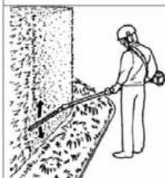
Fig.HT12 Corte vertical: corte sin permanecer directamente
