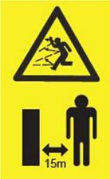
Danger de blessure en raison des projections ! Maintenez toujours une distance de sécurité suffisante. Maintenir les tierces personnes à l'écart. La distance entre la machine et les tierces personnes doit être au moins de 15 mètres.
