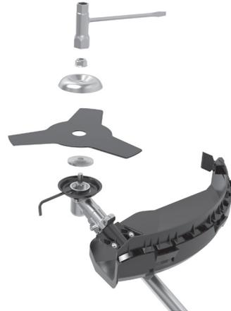
Pour démonter la lame, insérez un outil de verrouillage métallique dans le trou sur le côté du pignon moteur et sur la transmission. Desserrez l'écrou de serrage, puis retirez tous les éléments.
