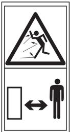
Attention aux objets projetés. La distance entre la machine et les personnes doit être d'au moins 15 m.
