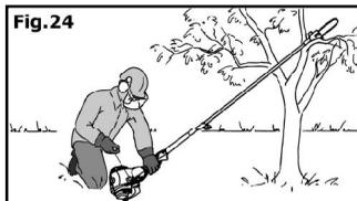
Pour réduire le risque d'accident dû à une perte de contrôle, s'assurer que le guide de chaîne et la chaîne ne soient pas à proximité ou ne risquent pas de rentrer en contact avec des personnes ou quelque obstacle que ce soit, y compris le sol, car le régime moteur au démarrage est susceptible d'entraîner la chaîne.
