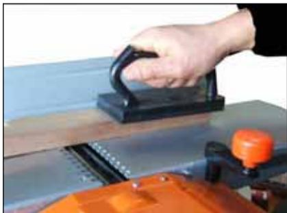
Lorsque vous utiliser la machine en mode dégauchisseuse, utiliser TOUJOURS les 2 poussoirs pour manier la pièce à usiner par mesure de sécurité.
