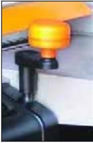
Pour ajuster ou diminuer la profondeur de coupe en mode rabot, tournez la poignée (cf. schéma ci-dessous) dans le bon sens selon votre besoin : diminuer ou augmenter la profondeur et reportez-vous à la graduation.
