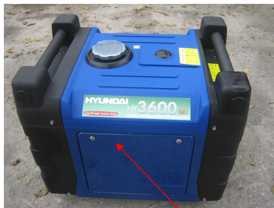
6 : TRAPPE DE MAINTENANCE
