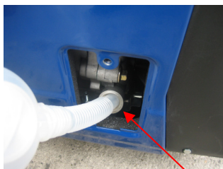
21 : BOUCHON ET ORIFICE DE REMPLISSAGE ET DE VIDANGE DU CARTER D'HUILE MOTEUR
