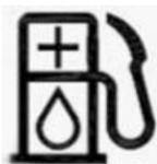
Remplissage de carburant (sur le bouchon du réservoir de carburant)
