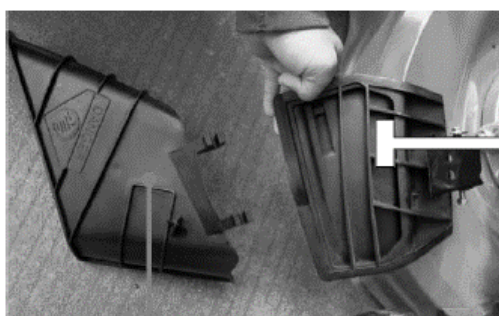
Panneau de guidage de décharge latérale de l'herbe
