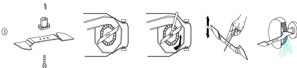
Pour retirer la lame, desserrez la vis, vérifiez le support de la lame et remplacez toutes les pièces si elles sont usées ou endommagées.
