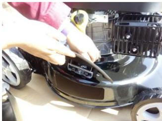
d) Fixer le déflecteur dans les crochets réservés à cet effet. Vérifiez que le déflecteur est bien tenu en place par la force du ressort de l'obturateur.
