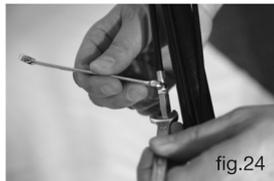
Remarque : Laissez une garde d'environ 2 cm sur le levier d'avance. La tondeuse doit commencer à avancer progressivement à partir de ce point.
