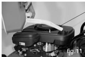
sali d'essence et essuyez soigneusement la tondeuse. Tout essai de démarrage doit être évité jusqu'à ce que les vapeurs d'essence soient complètement volatilisées.
