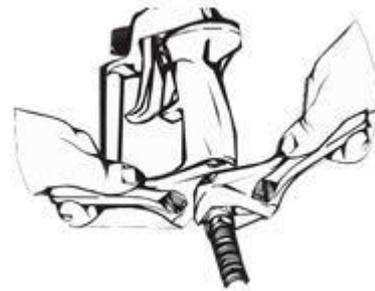
Retirez le filtre du pistolet pulvérisateur (voir Nettoyage du filtre du pistolet pulvérisateur)
