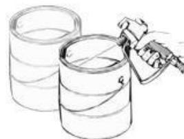
1. Lorsque la solution de nettoyage sort du pistolet pulvérisateur, maintenez la gâchette enfoncée et dirigez le pistolet pulvérisateur sur le côté du récipient à déchets (mettez le pistolet à la terre avec un récipient métallique si vous rincez avec un solvant inflammable).
