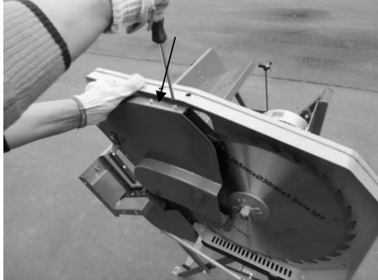
8. Assemblez la protection extérieure de la lame de scie, retirez d'abord le couvercle en plastique inférieur de la protection intérieure, montez la protection extérieure et serrez les boulons de la protection extérieure, puis montez le couvercle en plastique inférieur.
