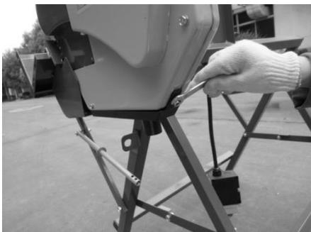
9. Assemblez la rallonge de la table de travail, utilisez 2 boulons (M8X12), 2 rondelles (Ø8) et 2 écrous de blocage (M8) pour connecter la rallonge à la table de travail.
