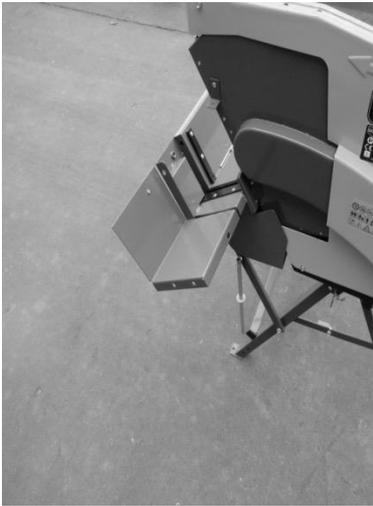
10. Assemblez la plaque de recouvrement de la table, utilisez 3 boulons (M8X15), 3 écrous de blocage (M8) pour connecter la plaque de recouvrement de la table à la table de travail puis utilisez 2 boulons (M5X8), 2 écrous de blocage (M5) pour relier la plaque de recouvrement de la table à la protection intérieure de la lame de scie.
