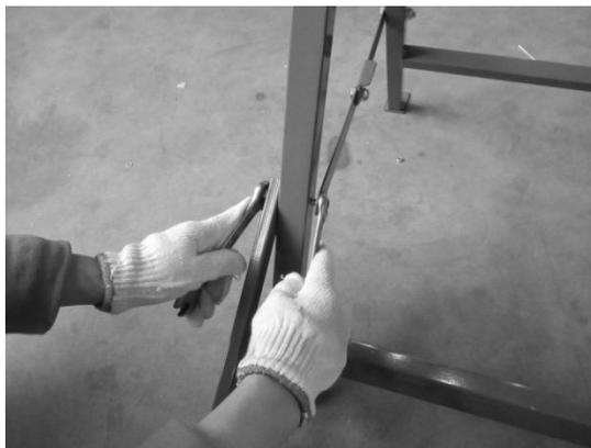
2. Assemblez la tige, utilisez les boulons M8X25 et M8 pour fixer. Ne serrez pas afin que la tige puisse bouger.
