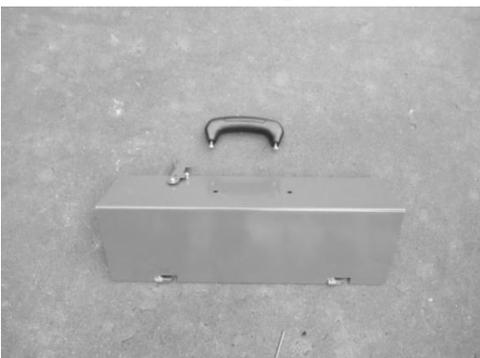
b. Dévissez 2 vis (M4X6) du couvercle de la table, puis connectez-le à la plaque de recouvrement de la table et serrez 2 vis (M4X6).
