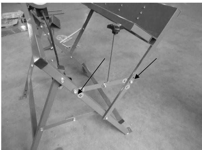
3. Assemblez la protection extérieure de la lame de scie sur le pied de support (B) et le support de protection avec un boulon à tête fraisée cruciforme (M6x15), un boulon (M8x40), un boulon (M8X15), un écrou de blocage (M6) et un écrou de blocage (M8).
