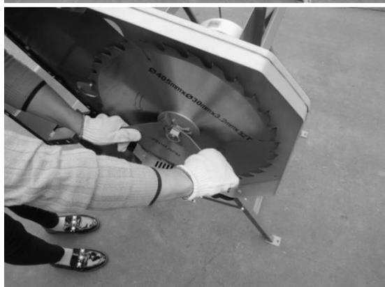
7. Assemblez l'extérieur de la protection interne de la lame de scie, connectez-le à la table de travail à l'aide de 2 vis (M6x12), puis utilisez des vis (M5x6) pour connecter l'extérieur et l'intérieur de la protection interne de la lame de scie.
