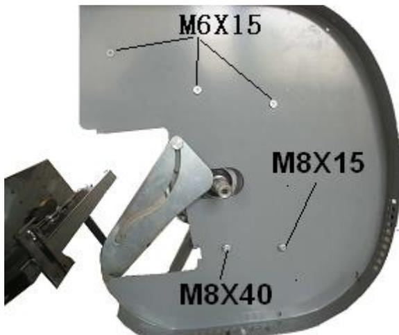
3. Monter le carter externe gauche de la lame sur le pied (B) et le support de carter avec 3 vis cruciformes (M6 x 15), 3 rondelles plates (Ø6), 3 écrous autobloquants (M6), vis (M8 x 40), vis (M8 x 15), 2 écrous autobloquants (M8)
