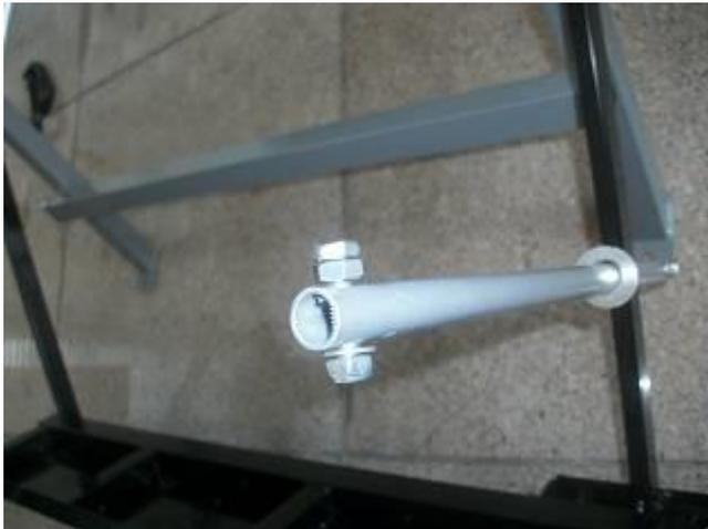
1. Desserrer le boulon à tête ronde, la rondelle plate et l'écrou autobloquant sur le tube du guidage du ressort.
