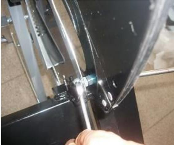
7. Puis monter ce guide (10) sur le carter interne gauche de lame, serrer l'écrou autobloquant (M5) et NE PAS serrer la vis.
