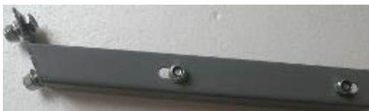
1. Desserrer tous les boulons et écrous autobloquants sur le support de carter.
