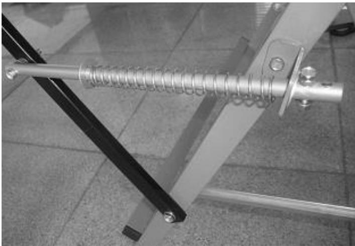
2. Mettre le ressort et la rondelle sur le tube de guidage, pousser le pied (A) vers la lame, et insérer le tube de guidage de ressort dans l'orifice du pied (B), et le serrer avec le boulon à tête ronde (M6 x 25 avec écrou), les rondelles plates (Ø6) et l'écrou autobloquant (M6)
