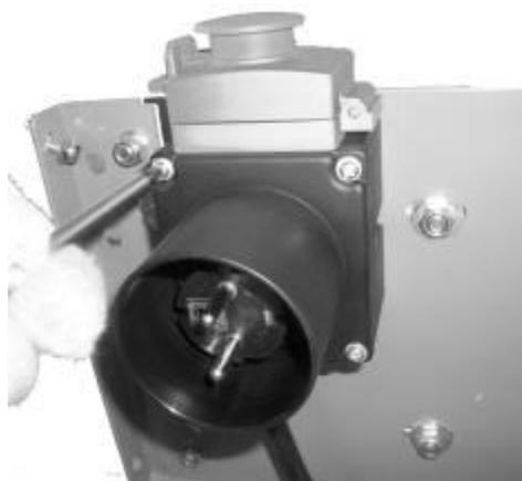
2. Monter l'interrupteur sur la plaque de moteur avec 4 boulons (M4 x 55) et 4 rondelles (Ø4)
