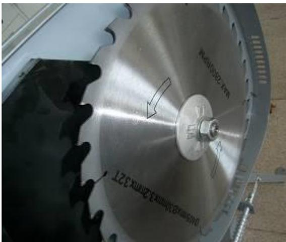
9. Mettre la joue interne, la lame, la joue externe et l'écrou sur l'arbre du moteur. Maintenir la joue externe avec la clé et serrer l'écrou avec l'autre clé.
