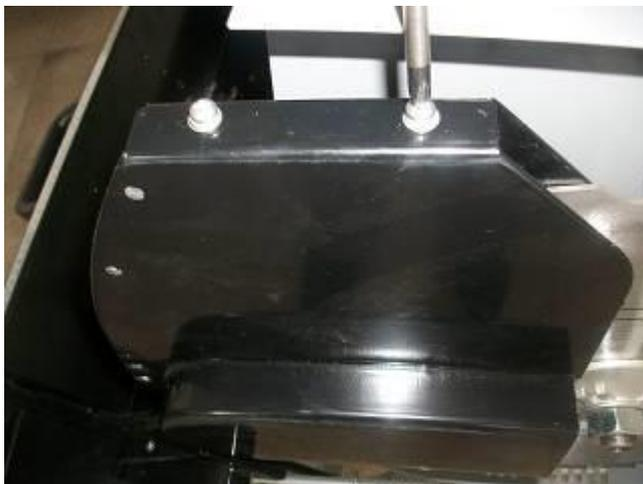
11. Serrer la carter interne de lame avec 2 vis à tête semi-ronde (M5 x 12) et deux rondelles ressort (Ø5) et ne pas serrer les vis.
