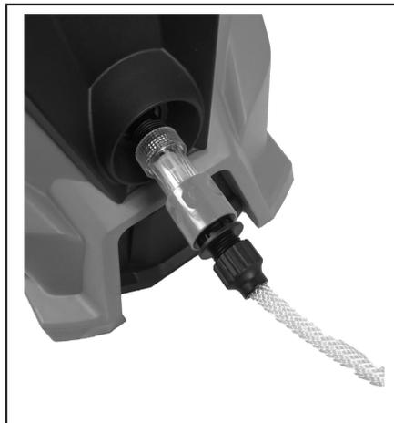
La longueur minimale recommandée pour le tuyau d'alimentation en eau est de 10 mètres (mais pas plus de 25 mètres), avec un diamètre de 12,5 mm pour éviter toute contre-pression et tout dommage potentiel à votre appareil. Assurez-vous qu'il peut résister à l'eau et à une pression maximale de 10 bars (0,1 Mpa). Si vous souhaitez connecter votre appareil à d'autres sources d'eau, assurez-vous que la pression d'entrée d'eau maximale est de 10 bars (0,1 Mpa).
