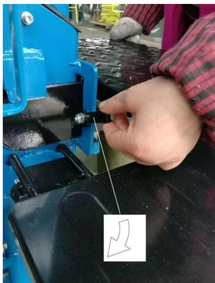
Remarque : La flèche fait référence au sens d'installation de la plaque de stockage des deux côtés, et le côté indiqué par la flèche doit être proche de l'utilisateur.
