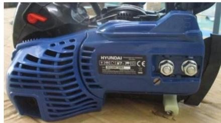
7. Réglez la tension de chaîne en tournant la vis de tension jusqu'à ce que les courroies d'attache touchent juste le côté bas de la barre.
