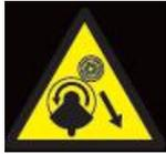
Mise en garde! L'outil peut entrer en contact avec un matériau volumineux. Une perte de contrôle et des blessures peuvent être créés.
