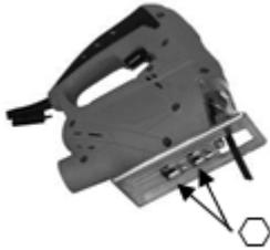
Dévissez les 2 vis pour régler la base à un angle de 45 ° à droite ou à gauche.
