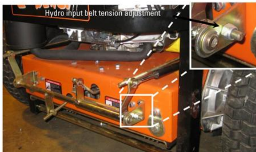
Réglage de la la tension de la poulie d'entrée
