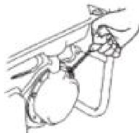
Alinhe o entalhe na polia do arrancador com o orifício no topo do motor de arranque de recuo.
