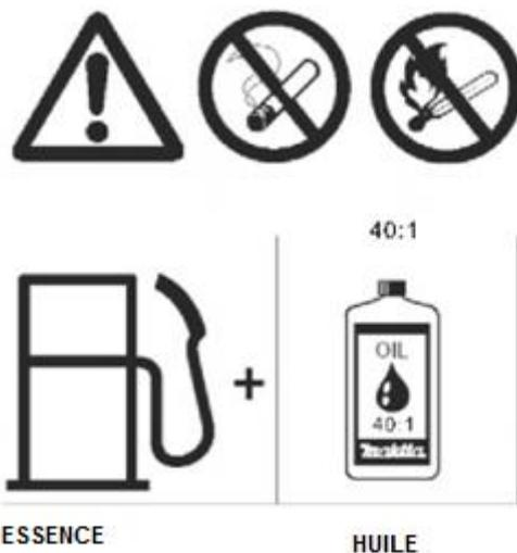
**REMARQUE** Pour préparer le mélange carburant-huile, mélangez d'abord toute la quantité d'huile avec le carburant requis, puis ajoutez le carburant restant. Bien agiter le mélange avant de le verser dans le réservoir (utiliser le bidon fourni pour le mélange).
