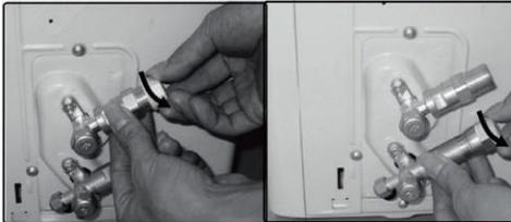
2. Richten Sie die Kühlmittelrohre korrekt aus und ziehen Sie die ersten Gewinde handfest an.
