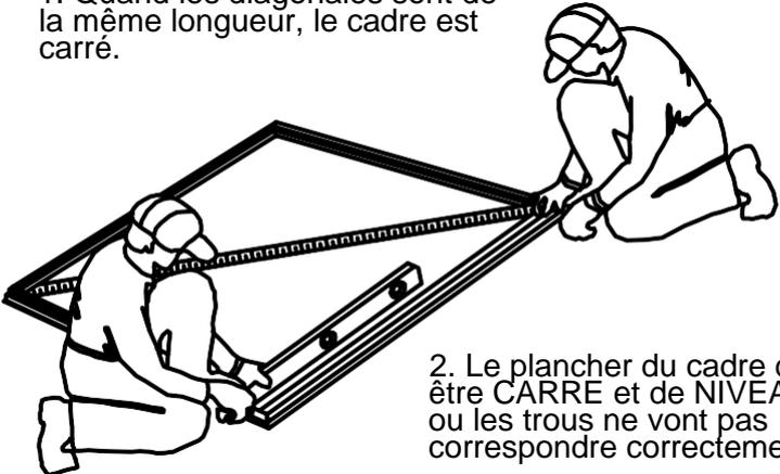
2. Le plancher du cadre doit être CARRE et de NIVEAU ou les trous ne vont pas correspondre correctement.
