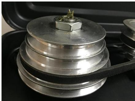
**Remarque:** ne faire fonctionner la perceuse qu'avec la courroie de niveau. Faire fonctionner la perceuse avec la courroie inclinée occasionnera de graves dégâts à l'outil et invalidera la garantie.
