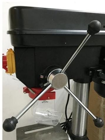
7. Enlever les vis (x 3) et l'écrou (x 1) qui sont préinstallés au carter de mandrin pour sécuriser la visière de carter de mandrin. Installer la visière puis remettre les vis et écrous en position d'origine. Installer le dispositif sur la machine et le serrer en sécurité.
