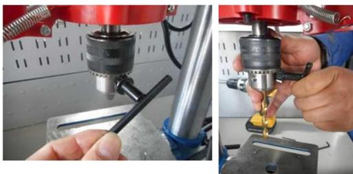
**Remarque** : S'assurer que le mandrin est bien serré avant d'essayer de percer, car sinon cela peut occasionner des dégâts permanents au mandrin et peut invalider la garantie. **AVERTISSEMENT** : Ne jamais mettre d'accessoire dont la vitesse maximum est inférieure à celle de la machine sans charge.
