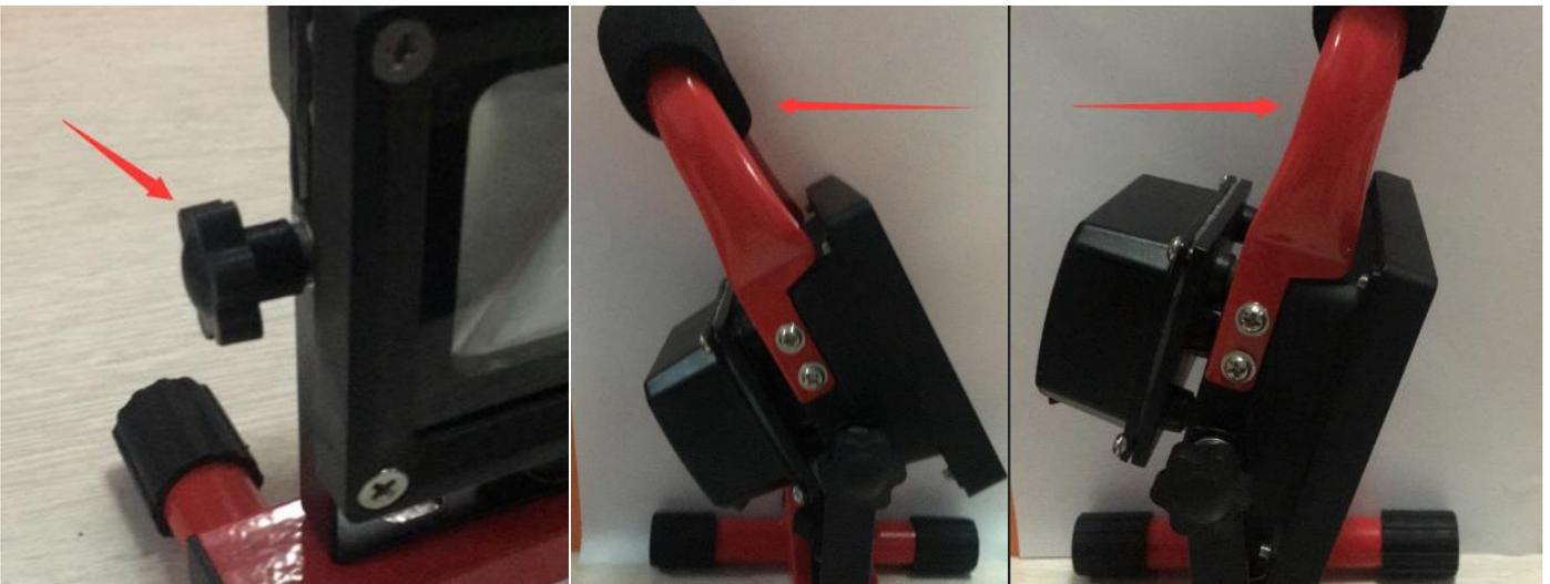
Lösen Sie die Drehknöpfe am Sockel, um die Drehung des Leuchtenkopfes so einzustellen, dass das Licht gezielt ausgerichtet werden kann. Den Drehknopf wieder festziehen, um die Position zu sichern.
